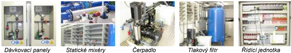
Obr. 3 Základní komponenty mobilních úpraven vody [8]
