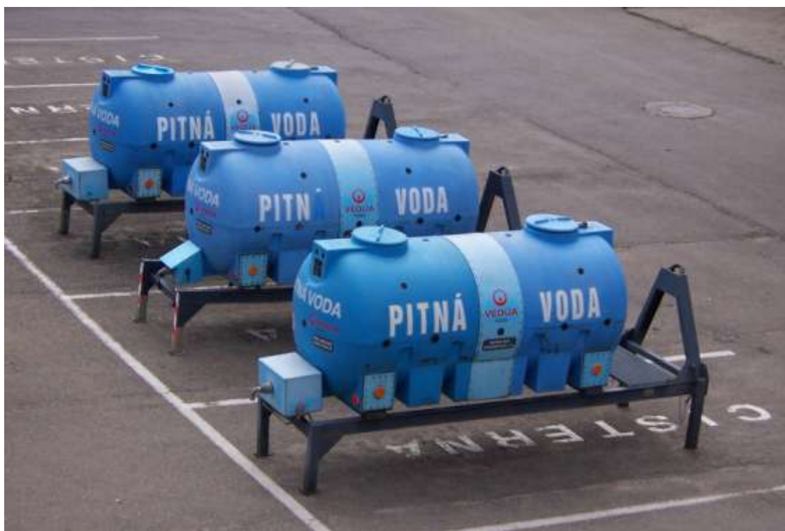
Obr. 1 Příklad cisterny s pitnou vodou na stabilních vaznicích [4]
